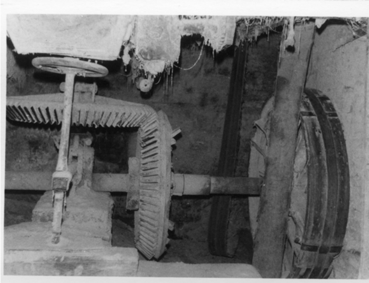
Foto 11: Aandrijving steenkoppel ( foto Walter)
